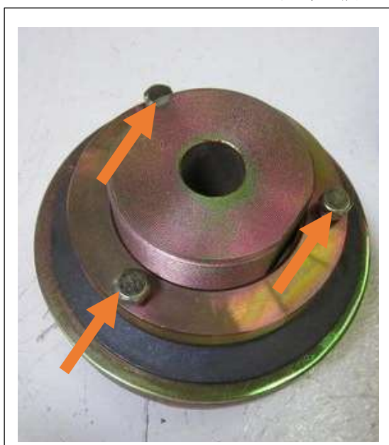
TL500、TL700 : M6 調整ボルト 3箇所を均等に少しずつ締める
